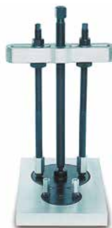
Estrattore durante lo smontaggio di ruote dentate
