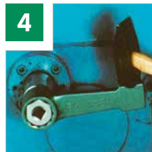
Le chiavi poligonali a percussione STAHLWILLE n. 8 con esagono doppio sono più resistenti, più sottili e più alte.
